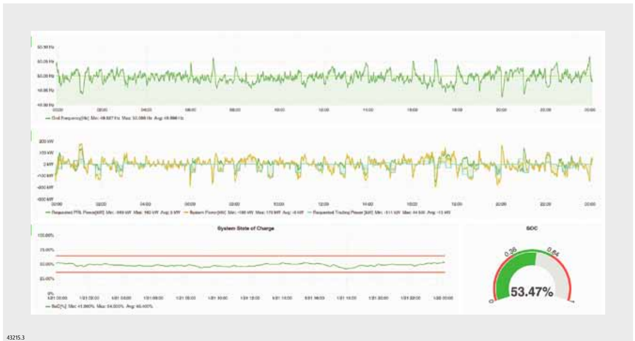
Bild 3. Leitsystem für das Monitoring der Energiespeicher
